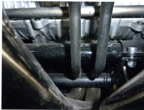
Ein Blick zwischen die Krümmeranlage der XJR 1300. Am Querrohr des Motorradrahmens liegt ein Befestigungspunkt für den Beiwagen.
