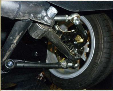
Das Chassis des Mega2 wirkt zerklüftet. Unter dem Boot führt das Lenkgestänge vom Vorderrad zum Beiwagenrad.
