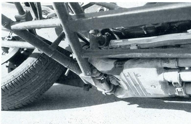
**DER FJ-LATERALFRAME IST MIT DEM COMETFAHRGESTELL AN DER HAUPTSTÄNDERPLATTE, AM RECHTEN FUßRASTENAUSLEGER UND IM VORDEREN BEREICH DES RAHMENUNTERZUGES VERSCHRAUBT.**
