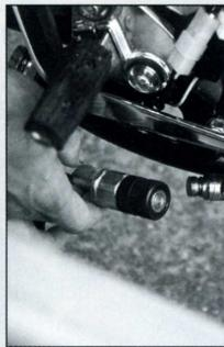
...hinten eine Schraube lösen, den Elektrikstecker ziehen und die Schnellkupplung der Bremsleitung lösen. Schon wird das Toro zur Solo-TDM.
