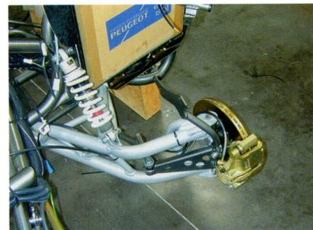
Die Vorderradföhrung des Zeus mit innenbelüftet Bremsscheibe. Hinter dem Peugeot-Karton verdeckt sitzt der große Wasserköhrler.
