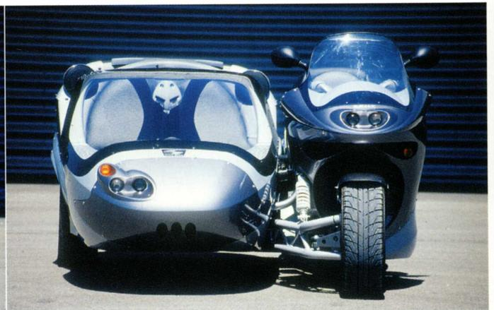
Noch muss man die Zeus-Sitzbank komplett entfernen, um den Kofferraum im Motorrad beladen zu können. Zum Pariser Salon stellt Side-Bike jedoch eine modellgepflegte Variante mit Gasdruckhebern vor.
