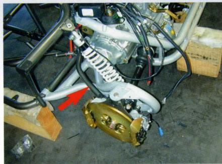
Die Hinterradföhrung des Zeus: Die Bremsscheibe wird speziell für Side-Bike hergestellt. Deutlich zu erkennen ist auch die Lenkstange für das Hinterrad (Pfeil).
