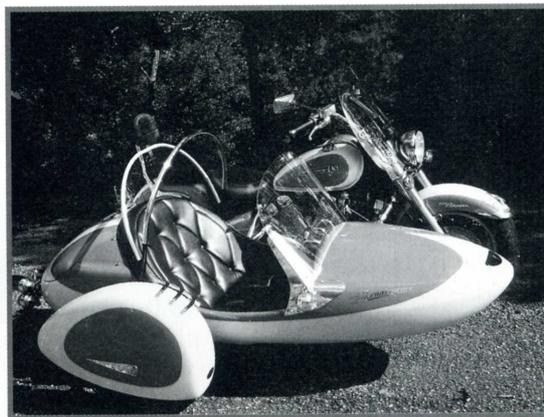
Ein Cabriogestänge bildet das Gerüst für das Verdeck, das auch größeren Beifahrern Kopffreiheit bietet. Der Einstieg ist durch die weit ausgeschnittene Klappe einfacher als beim Comete oder Kyrnos.
