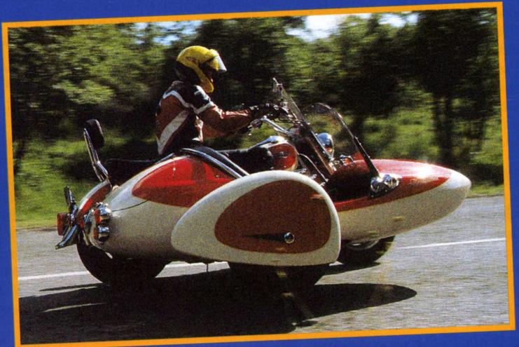
Das Renaissance-Gespann ist generell wahlweise zu fahren. Räder, Gabeln und Federbeine bleiben original. Die derzeit verfügbaren Umbausätze bestehen aus mehrfach mit dem Motorrad verschraubten Unterzügen sowie zwei Klemmen für die Oberzüge. Am Beiwagen kommt das bewährte Doppelstockchassis zur Aufnahme der Beiwagenachsschenkelenkung zum Einsatz.
