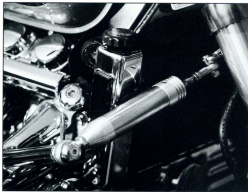
Die Lenkhydraulik am Motorrad bewegt über Leitungen und ...
