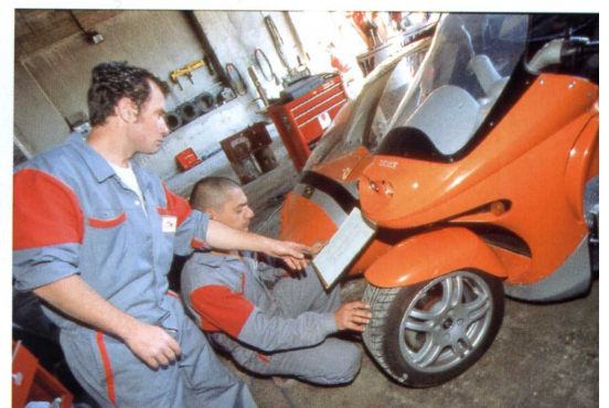
In der Werkstatt werden alle Zeus-Gespanne kostenfrei gecheckt. Die Überprüfung des Lenkgestänges gehört zum Wartungsplan.
