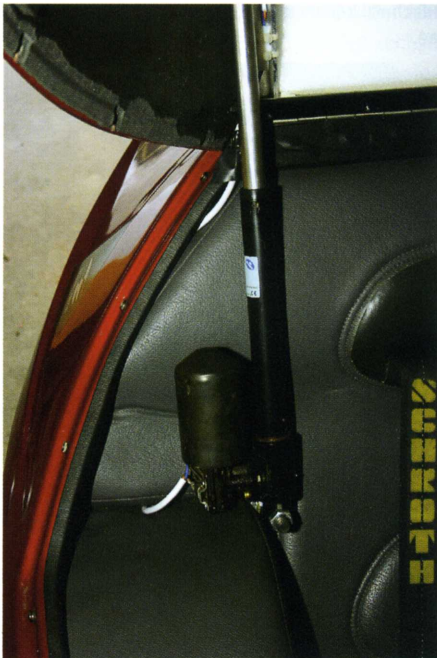
Ein Scheibenwischermotor mit Gewindestange öffnet bzw. schließt das Hardtop.
