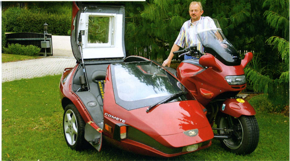
Dach- und Seitenklappe sind geöffnet. Das Dach wird elektrisch hochgefahren.
