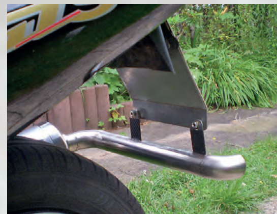
Messfehler: Die Bohrungen in den Laschen mussten nach oben versetzt werden.
