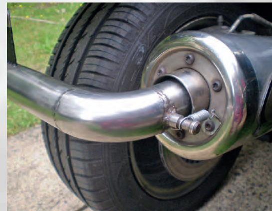
Winkelbleche am Auspuff und an der angeschweißten Schraube dienen der Feder als Zugpunkte. Die Stärke der Feder wird so gewählt, dass der Krümmer vibrationsfrei am Topf anliegt.
